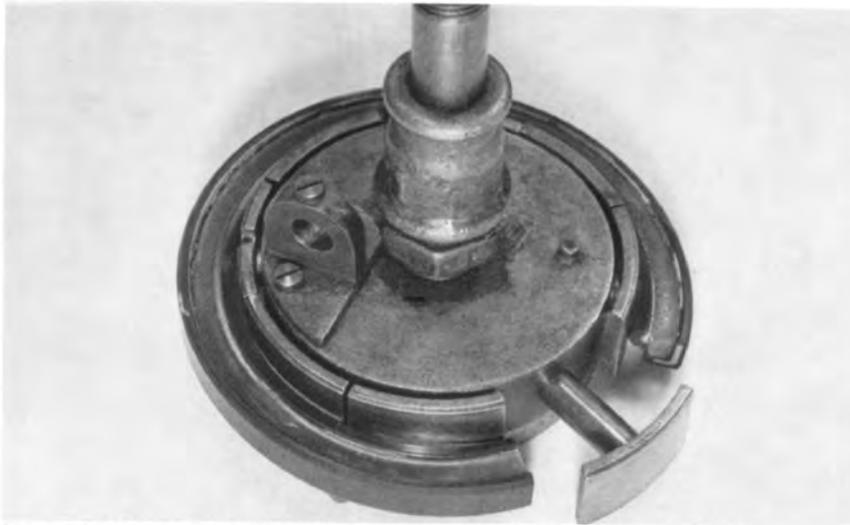
Bild 2: Erstes hydraulisches Radialkraftmeßgerät, 1940 an der TH Karlsruhe gebaut
