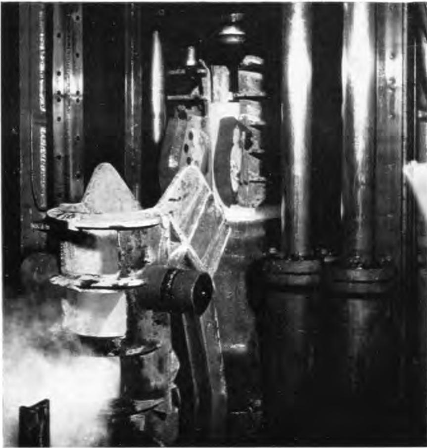
Auslaufseite des Asselwalzwerkes (Dreiwalzenstreckwalzwerk) mit gestrecktem Lochstück
