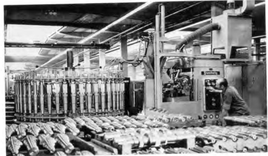
Moderne Abwälzfräsmaschine für die Bearbeitung von Getriebewellen
