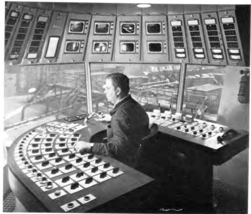
Steuerbühne einer kontinuierlichen Drahtstraße. Die Haupt- und Hilfsantriebe mit Gleichstrommotoren von zusammen 24 000 kW werden über Thyristoren gespeist.
