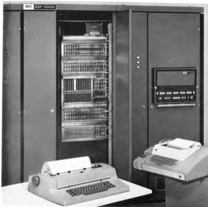
Das BBC-Prozeßrechnersystem DP 1 000 dient zur Automatisierung technischer Prozesse. Hardware und Software sind modular aufgebaut. Das System kann den verschiedensten Automatisierungsaufgaben in Art und Umfang leicht angepaßt werden. Die Programmierung wird problemorientiert in der Prozeß-Automations-Sprache PAS 1 durchgeführt.
