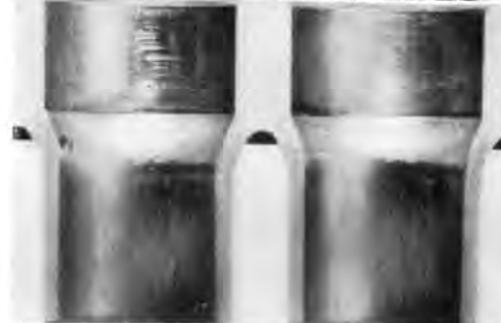
Makroschliff der Rohrverbindung
