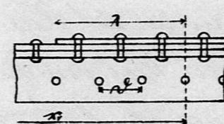
Die Enden der neu aufgelegten Gurtpfosten müssen nach dem früher gesagten noch um eine gewisse Länge  $x$  über die theoretisch bestimmte Stelle ( $x$ ) hinausragen.  $x$  soll mindestens so lang sein, dass darauf so viel Vertikalseilen Platz finden als dem nutzbaren Plattenquerschnitt entspricht. Ist
