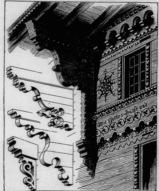
Abb. 30. Details eines Blockhauses.
