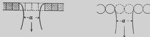
Dazu kommt, daß bei größeren Stauhöhen den kantigen Nadeln eine geringere Breite gegeben werden muß, um ihr Gewicht zu vermindern; es sind also z. B. zur Herstellung der nutzbaren Ausflußöffnung  $a$  von kantigen Nadeln 4, von runden nur 2 zu ziehen.
