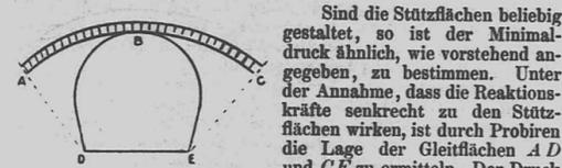
Sind die Stützflächen beliebig gestaltet, so ist der Minimaldruck ähnlich, wie vorstehend angegeben, zu bestimmen. Unter der Annahme, dass die Reaktionskräfte senkrecht zu den Stützflächen wirken, ist durch Probiren die Lage der Gleitflächen AD und CE zu ermitteln. Der Druck auf die Tunnelwände ergibt sich sodann als Druck der nach der Fläche ABC begrenzten Erdmasse, welche längs ihrer Oberfläche durch den spez. Vertikaldruck v belastet ist.
