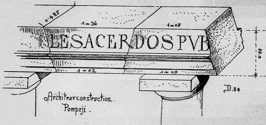
die früher übliche einfache Construction bei der allerdings erheblichen Spannweite von nahezu 5 m zu verbessern (Fig. 118).
